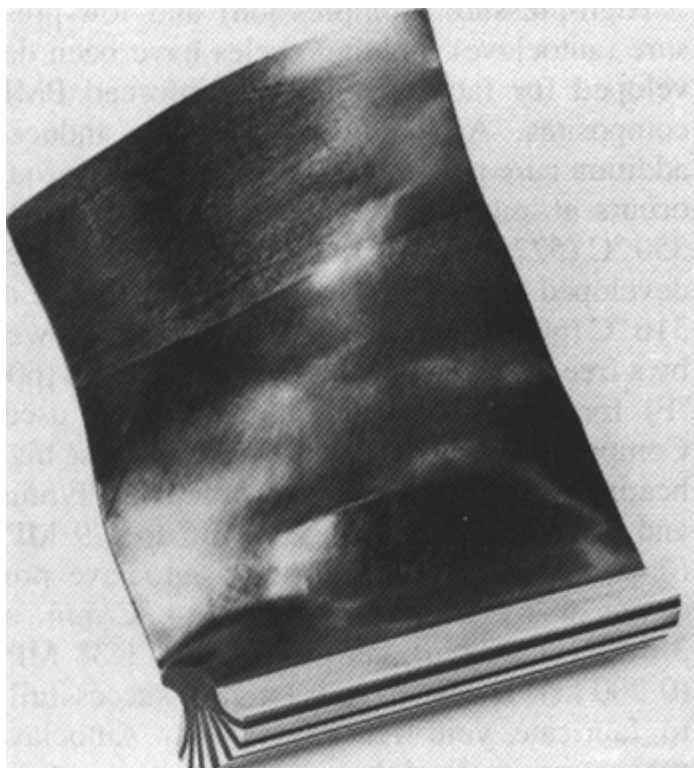
Fig. 3 Graphite fiber-PMR-15 fan blade
